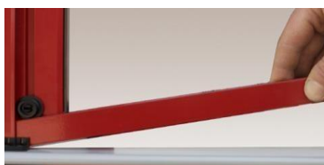
5 Inserire le guide superiore ed inferiore al cassonetto
